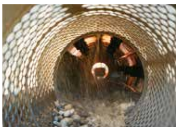
Trommel pre-clasificador en la descarga del cilindro
