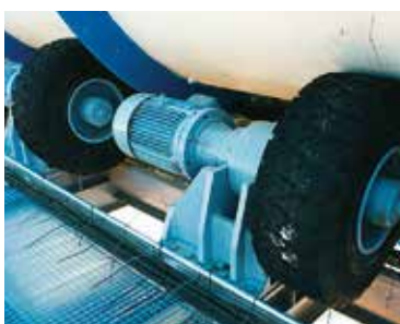
Sistema motriz mediante neumáticos con moto-reductores
